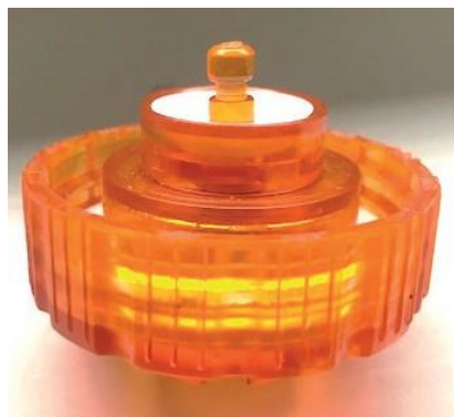
Korek uszczelniający w niewłaściwym miejscu
